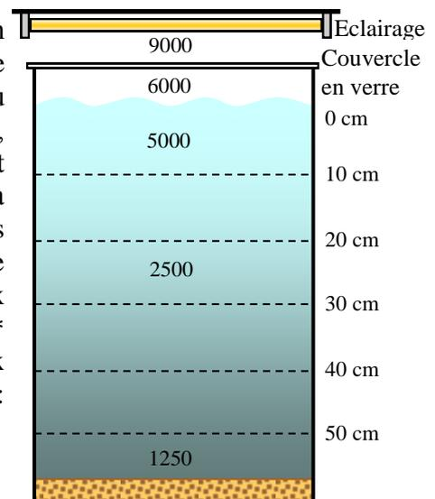
Fig. 3 : Mesure de l'intensité lumineuse (en lux) dans un aquarium en fonction de la hauteur d'eau
