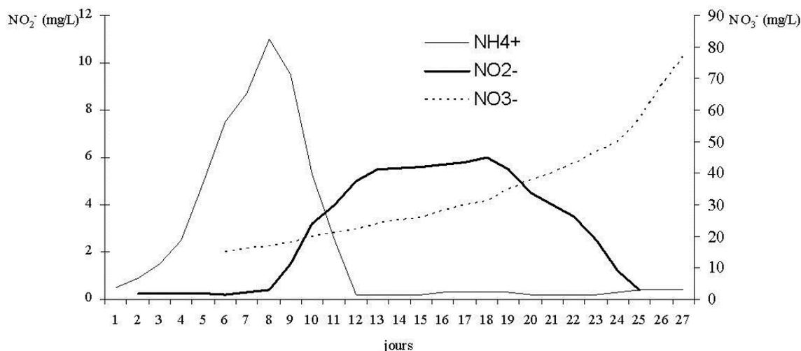
Fig. 5 : Evolution des concentrations en ammonium (NH<sub>4</sub><sup>+</sup>), nitrite (NO<sub>2</sub><sup>-</sup>) et nitrate (NO<sub>3</sub><sup>-</sup>) lors de la mise en eau d'un aquarium
